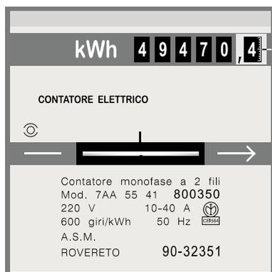
Nell'esempio riportato, la lettura è: **49470 kWh**; il "4" finale (4 /10 di kWh), dopo la virgola è trascurato.
